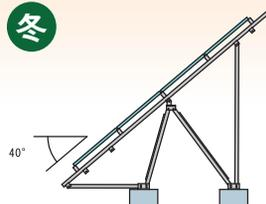
冬の太陽の高さは低い為、太陽光パネルの角度を40°以上にする事で発電効率をUP。積雪対策に対しても有効である。
